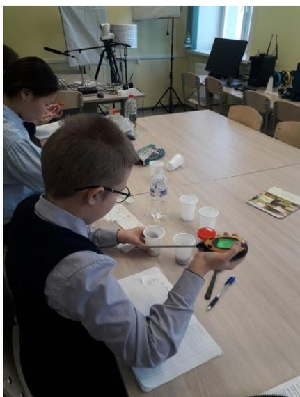
Рис. 5. Измерение уровня кислотности прибором РН метр АМТ 300
